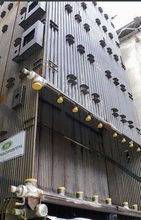
Pierwszy kocioł energetyczny wytworzony w technologii laserowej w CITL dla ECO SA.
