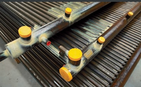
Ściany membranowe kotła spawane hybrydowo.
