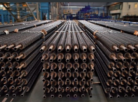
Kotłowe rury ożebrowane spawane laserowo.
