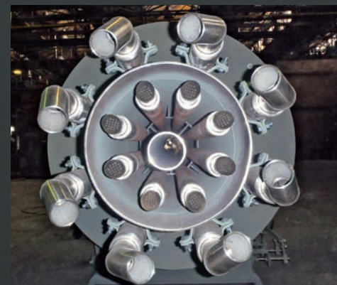
Palnik gazowy, wyprodukowany w zakładzie ENERGOINSTAL w Piechowicach.
